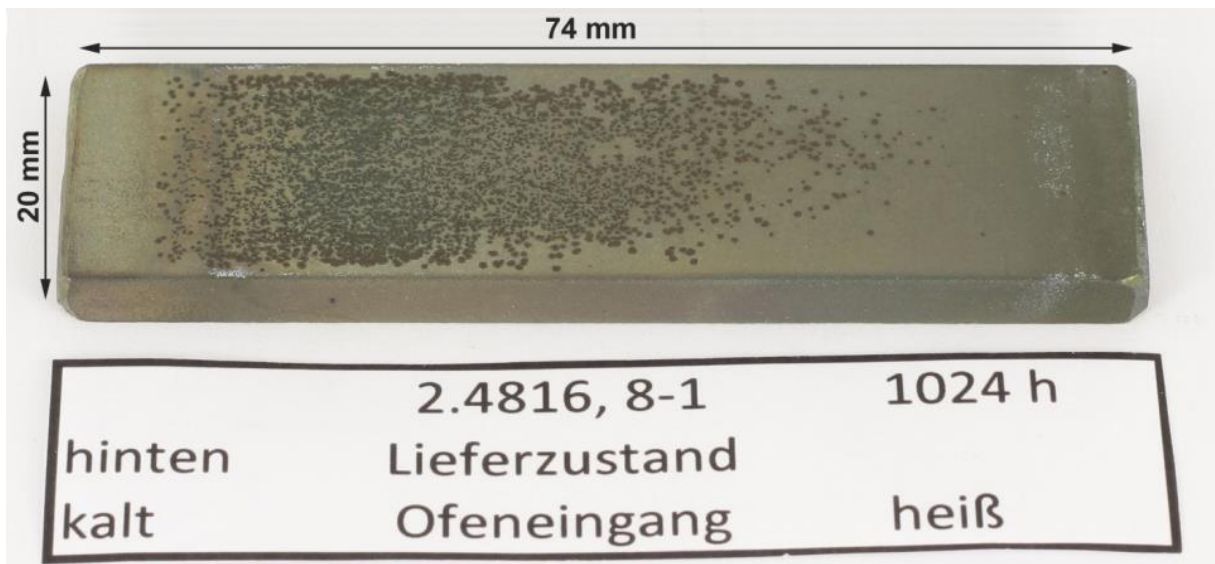
Abbildung 22: Fotografie der Probe 8-1 aus 2.4816, gebeizt, nach 1024 h Expositionszeit mit einem Metal-Dusting Schadensbild
