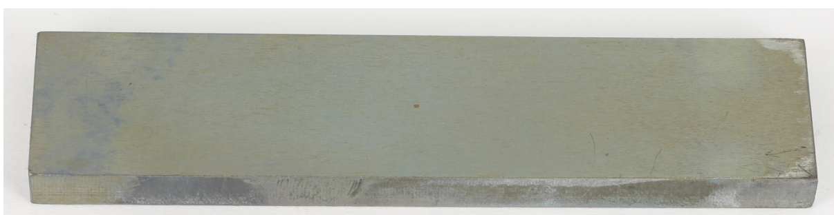
Probe 1-2 nach Versuch C, Kohlenstoffabscheidung oxidativ entfernt
