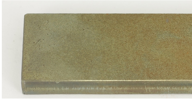
Abbildung 27: Beispiel für Kategorie „1-5 Pits“: 1.4828, Probe 2-4: Lieferausführung = (mechanisch entzündert) mit Beschichtung (200 nm) aus \text{Al}_2\text{O}_3 nach 991 h im Versuch E
