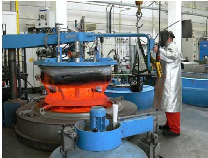
Abbildung 32: Schacht- bzw. Topföfen der Härterei Tandler, in dem die Feldversuche durchgeführt wurden
