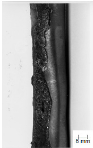
Abbildung 39: Metal-Dusting-Schadensfall: Sauerstoffsonden-Schutzrohr aus 2.4816 (Alloy 600)
