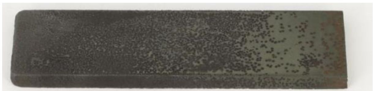
2.4816, Probe 8-2: Lieferausführung (= gebeizt) nach 3003 h im Versuch A
