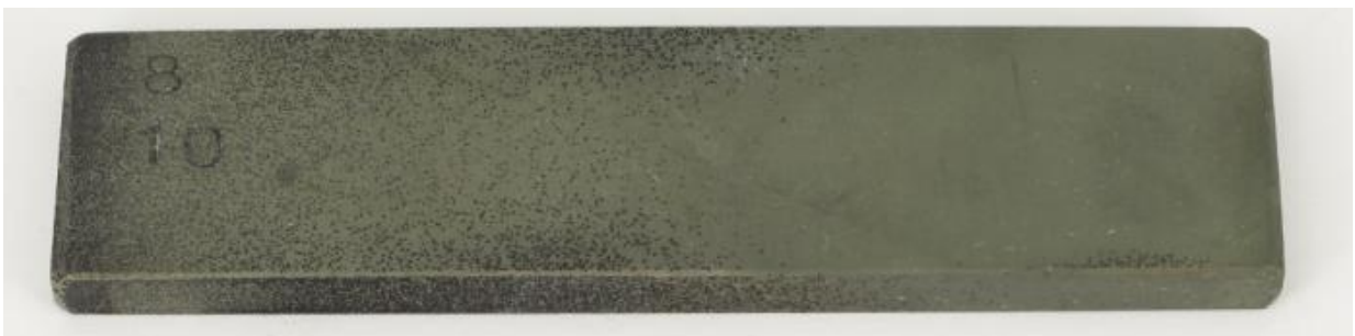
Abbildung 28: Beispiel für Kategorie „zahlreiche kleine Pits bis \text{Ø}=1 mm“: 2.4816, Probe 8-10: Oberfläche sandgestrahlt nach 637 h im Versuch B
