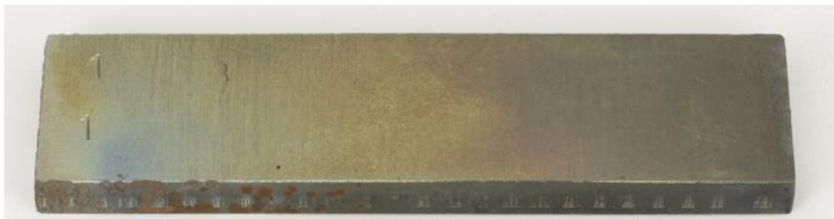
Abbildung 26: Beispiel für Kategorie „kein Angriff“: 2.4851, Probe 1-1: Lieferausführung (= mechanisch entzundert) nach 3003 h im Versuch A
