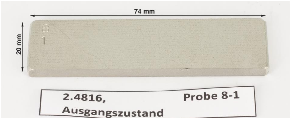
Abbildung 21: Fotografie der Probe 8-1 aus 2.4816, gebeizt, Ausgangszustand
