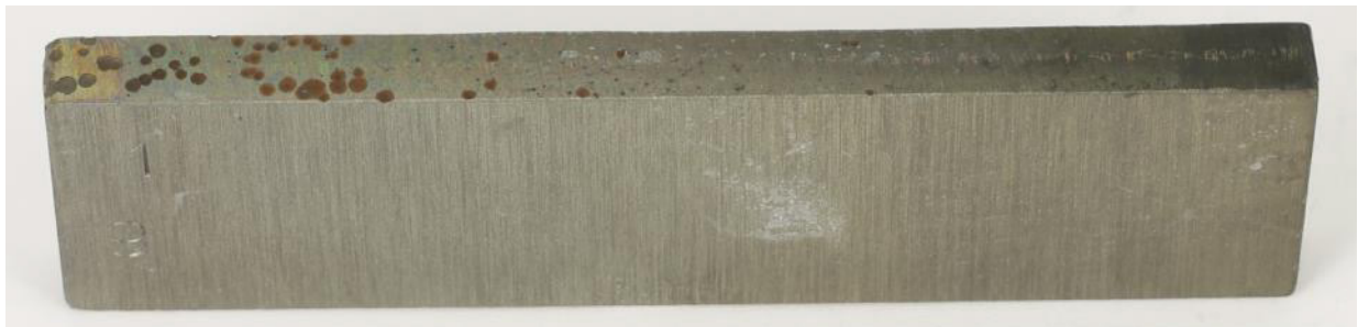
Abbildung 57: MD-Angriff auf der Schnittfläche einer mit Laserstrahlschneiden gefertigten Probe des Bleches aus dem Werkstoff 2.4851 nach 3003 h Exposition im Versuch A
