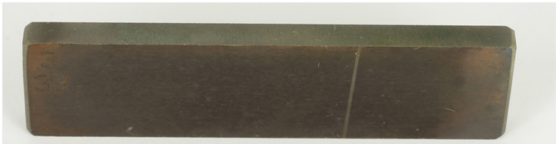
Abbildung 136: Makroaufnahmen der mechanisch entzunderten Oberfläche der Probe aus dem Blech des Werkstoffs 1.4841 von oben nach unten: - nach 2022 h Exposition im Feldversuch - nach 2000 h Exposition im Versuch B und D (im Versuch abgeschiedener Kohlenstoff wurde nicht oxidativ entfernt) - nach 1991 h Exposition im Versuch D und E (im Versuch abgeschiedener Kohlenstoff wurde oxidativ entfernt)
