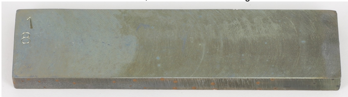
Probe 1-8 nach Versuch C, Kohlenstoffabscheidung oxidativ entfernt
