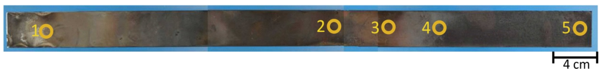
Abbildung 118: Werkstoff 2.4851 mit sandgestrahlter Oberfläche, Die nummerierten Markierungen zeigen die mit GDOES untersuchten Stellen. Die rechte Seite der Probe hat während des Feldversuches nach unten zum Retortenboden gezeigt.
