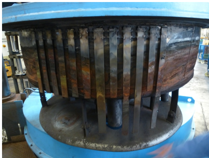
Abbildung 34: Anbringung der Proben an der Position 1 am Deckel des Schachtofens (hier nach ca. 3000 h Einsatz) (IWT)
