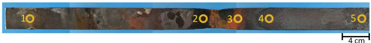
Abbildung 96: Werkstoff 1.4828 mit sandgestrahlter Oberfläche. Die nummerierten Markierungen zeigen die mit GDOES untersuchten Stellen. Die rechte Seite der Probe hat während des Feldversuches nach unten zum Retortenboden gezeigt.
