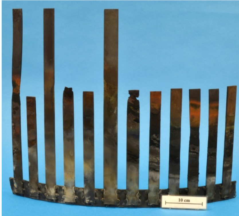
Abbildung 86: Befestigungsstreifen mit Proben nach dem Entnehmen aus dem Schachtofen nach 137 Tagen
